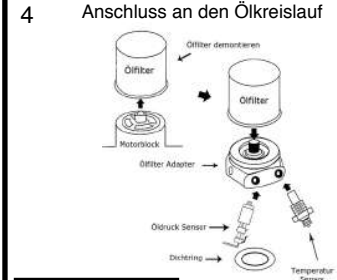
Ölfilter Adapter ist optional als Zubehör erhältlich
